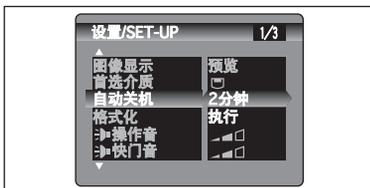
当启用该功能时,若相机被闲置30秒钟,显示屏将暂时关闭(进入睡眠模式),指示灯(绿)以1秒钟为间隔闪烁,以节约电量。相机若继续被闲置一段时间(2分钟或5分钟),将会关机。若想使尽量延长电池的使用时间,请使用该功能。
