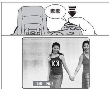
半按快门按钮，相机会发出简短的唧唧声。开始对焦拍摄对象。此时，显示屏上的AF(自动对焦)框变小，相机自动设定快门速度和光圈(指示灯(绿)从闪烁变为常亮)。
