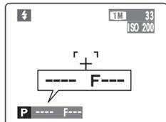
当拍摄对象的亮度超出相机亮度检测范围时，在屏幕上快门速度和光圈设置将被显示为“---”。
