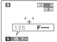
当拍摄对象的亮度超出相机亮度检测范围时，光圈设置被将显示为“F---”。出现这种情况时，请半按快门按钮，重新测量光照水平，并显示一个值。
