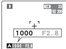
如果出现极端曝光过度时，快门速度(1/1000秒钟)显示为红色。发生这种情况时，请选择较大的光圈值(最大至F11)。
