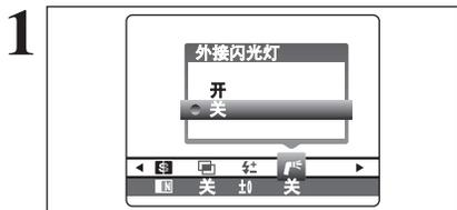
当使用外接闪光灯时, 请在该设置中选择“开”。可使用最快达1/1000秒的同步快门速度。
