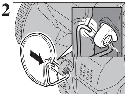
把金属环钩打开，将张开的金属环钩挂在相机上的手带安装孔中直至完全钩牢。
