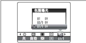
使用该模式，可用不同曝光设置拍摄同一图像。包围曝光功能可拍摄**3**幅连续画面，一幅正确曝光，另外两幅按照设定的偏差量，一幅曝光不足、一幅过度曝光。
