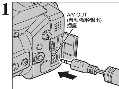
请关闭相机和电视机。将附带在相机中的音频/视频电缆插入“AV OUT”(音频/视频输出)插座。
