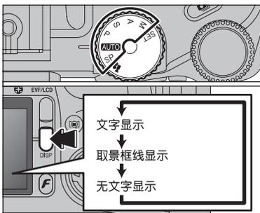
可在静止图像模式选择取景框线。每按一次“DISP”（显示）按钮，显示屏显示模式相应改变一次。连续按“DISP”（显示）按钮，直到出现“取景框线”为止。
