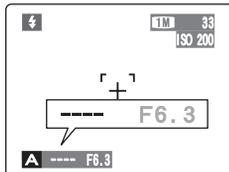
当拍摄对象的亮度超出相机的亮度测量范围时，快门速度将被显示为“----”。出现这种情况时，请半按快门按钮，重新测量光照水平，并显示一个值。
