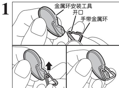
确认手带金属环的方向，将它完全滑进金属环安装工具，并打开金属环开口。
