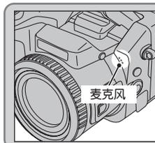
请对着相机正面的麦克风, 录下相应说明。请与相机保持约20cm的距离, 以获得最佳录音效果。
