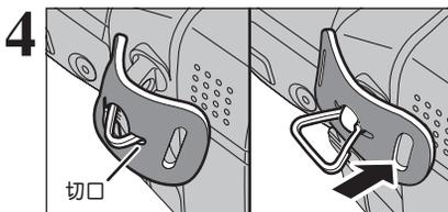
将保护套的黑色面对着相机，从切口侧开始将手带穿进金属环。
