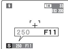
当出现极端曝光过度时，光圈设置(F11)被显示成红色。发生这种情况时，请选择较快的快门速度(最快至1/1000秒钟)。
