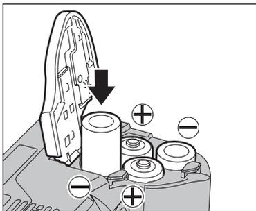
请按照极性图标指示正确装入电池。
