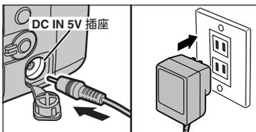
确认相机已关机。将AC电源适配器的连接器插入“DC IN 5V”插座,然后再将AC电源适配器插入电源插座。
