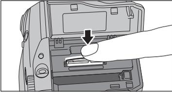
向卡插槽内轻推xD-Picture Card卡，然后慢慢移开手指。将解除锁定，自动弹出xD-Picture Card卡。
