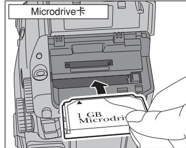
将Microdrive卡平稳地推入Microdrive卡插槽，直到推不动为止。
