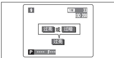
若显示“过亮”或“过暗”，表示未能在正确的曝光测量下进行白平衡。重新设定曝光补偿，当显示“过亮”时使用负值(-)、当显示“过暗”时使用正值(+)
