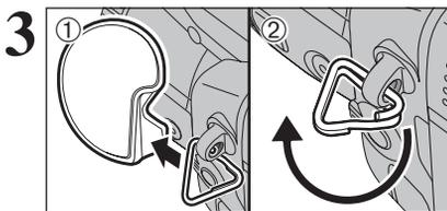
① 当金属环完全钩挂在手带安装孔后，让它保持钩挂状态的同时，将它从金属环安装工具中退出。
