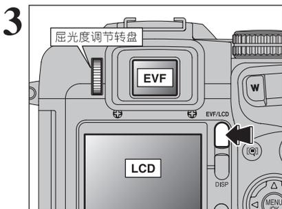
每按一次“EVF/LCD”按钮，显示方式在取景器(EVF)和显示屏(LCD)之间切换一次。如果取景器(EVF)中的自动对焦框很难看清楚，请用屈光度调节转盘调整取景器。
