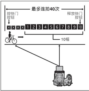
该模式最多可连续释放**40次**快门(最快**4.5幅/秒**)并保存**最后10幅**图像。如果在快门完成**40次**释放之前松开快门按钮的手指，相机将保存松开快门之前已拍摄的最后**10幅**图像。
