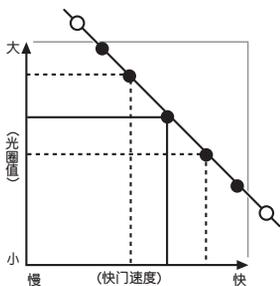
左图所示为保持相同曝光水平的前提下，光圈与快门的变化关系。
