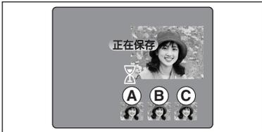
该模式以不同的曝光量拍摄**同一幅**图像。包围曝光将拍摄**3幅**连续的图像，以所选择的设置为中心进行**等差**曝光拍摄。
