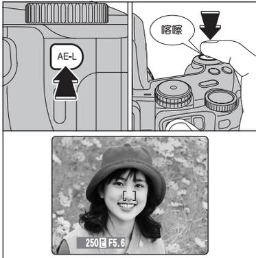
按住“AE-L”按钮的同时，半按快门按钮进行对焦，然后相对要拍摄的对象重新取景构图。
