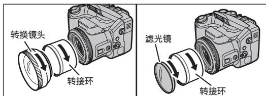
按照箭头方向转动，即可安装转接环、转换镜头和一般市售滤光镜。
