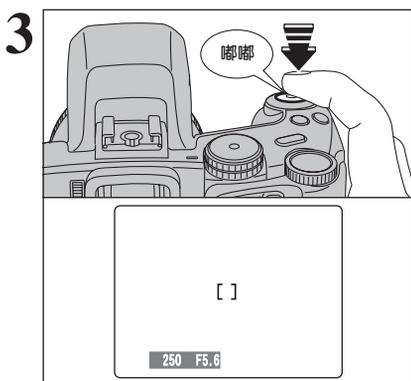
当半按快门按钮时，相机会发出简短的嘟嘟声并开始对焦拍摄对象。此时显示屏上的自动对焦框缩小，相机自动设定快门速度和光圈(指示灯(绿)停止闪烁并保持常亮)。
