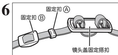
仅从手带的一端拆下固定扣(A)和(B)。将手带穿进镜头盖固定搭扣，然后再将穿回固定扣(A)和(B)。
