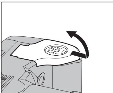
打开电池盒盖之前，请确认已关闭相机电源开关(指示灯已熄灭)。
