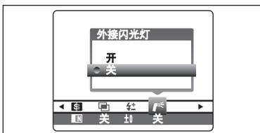
当使用外接闪光灯时，请将该设置选为“开”。可使用最快达1/1000秒的同步快门速度。
