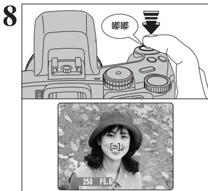
半按快门按钮，相机会发出简短的“嘟嘟”声，并开始对焦拍摄对象。此时，显示屏上的AF框变小，相机设定快门速度和光圈(指示灯(绿)从闪烁变为常亮)。
