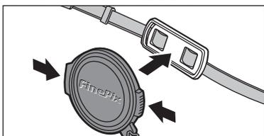
为了避免拍摄照片时镜头盖出现在镜头中，请将镜头盖安装在镜头盖固定搭扣上。
