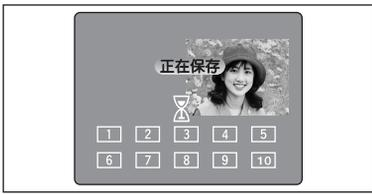
在该模式中，可以最多连拍**10幅**图像(最快**4.5幅/秒**)。当进行拍摄时，将(按从左向右的顺序)显示图像并进行保存。
