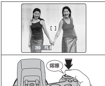
继续保持半按的快门按钮(AF/AE锁定)不放。将相机移回到原来的取景构图，然后将快门按钮按到底。
